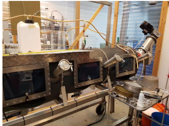
Torrötningsanläggning i labskala, med möjlighet att ta prov både på slam och gas i olika sektioner av reaktorn
